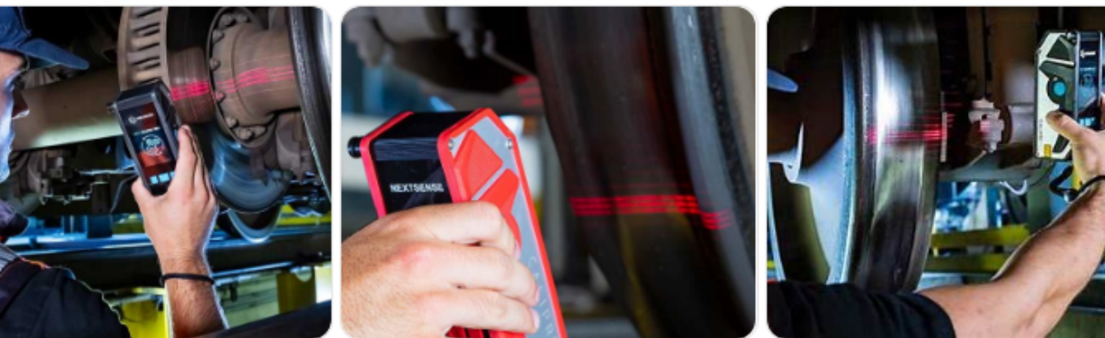
Рисунок 2 – Контроль геометрии колесной пары методом лазерного сканирования
