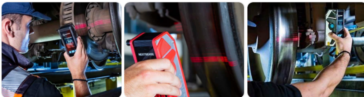
Рисунок 2 – Контроль геометрии колесной пары методом лазерного сканирования
